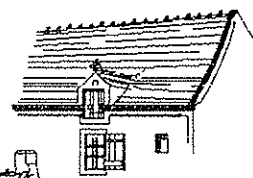
Lucarne dite "Ile de France"
