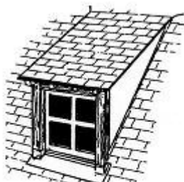
lucarne rampante ou en chien couché
