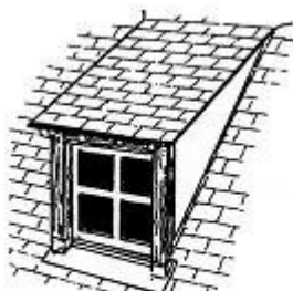
lucarne rampante ou en chien couché
