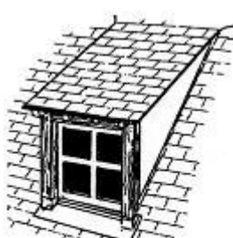
lucarne rampante ou en chien couché
