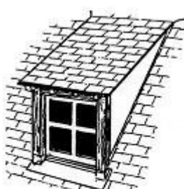
lucarne rampante ou en chien couché
